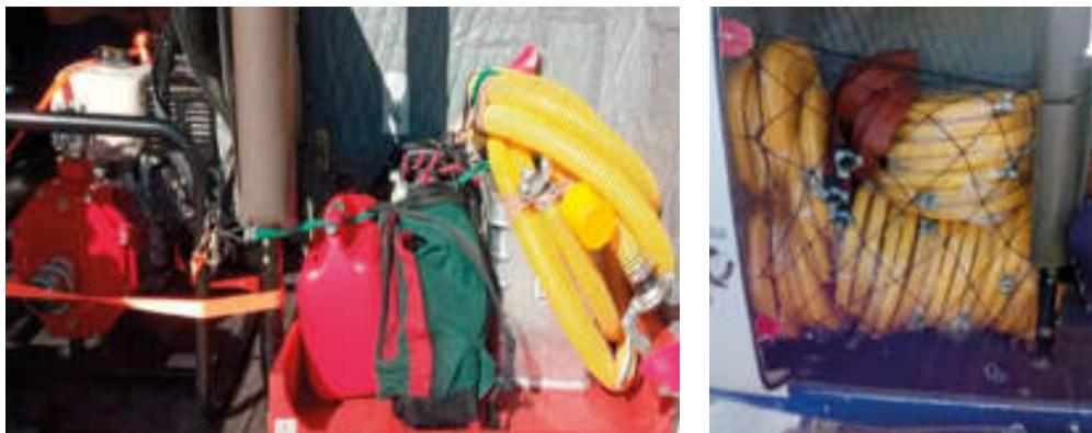
Repregar dous asentos para a bomba grande e fixar con cinchas nas argolas do chan. A bomba pequena e mangotes van no portaferamentas (compartimento lateral traseiro esquerdo). As mangueras e lanzas van no compartimento lateral traseiro dereito, levantando os asentos.
